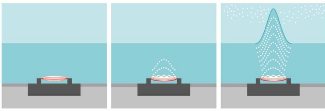
Obrázek 5.1 Princip vyvíjení vodní páry pomocí piezoměniče [9]
