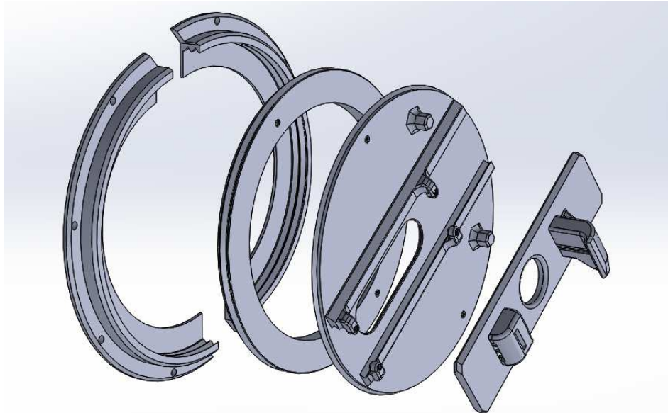
Obrázek 8.6 Nastavitelná konstrukce pro uchycení senzoru SPM, rozloženo
